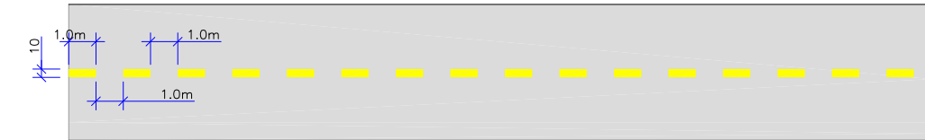
DETALHE D FAIXA SIMPLES CONTÍNUA AMARELA (BORDO)
