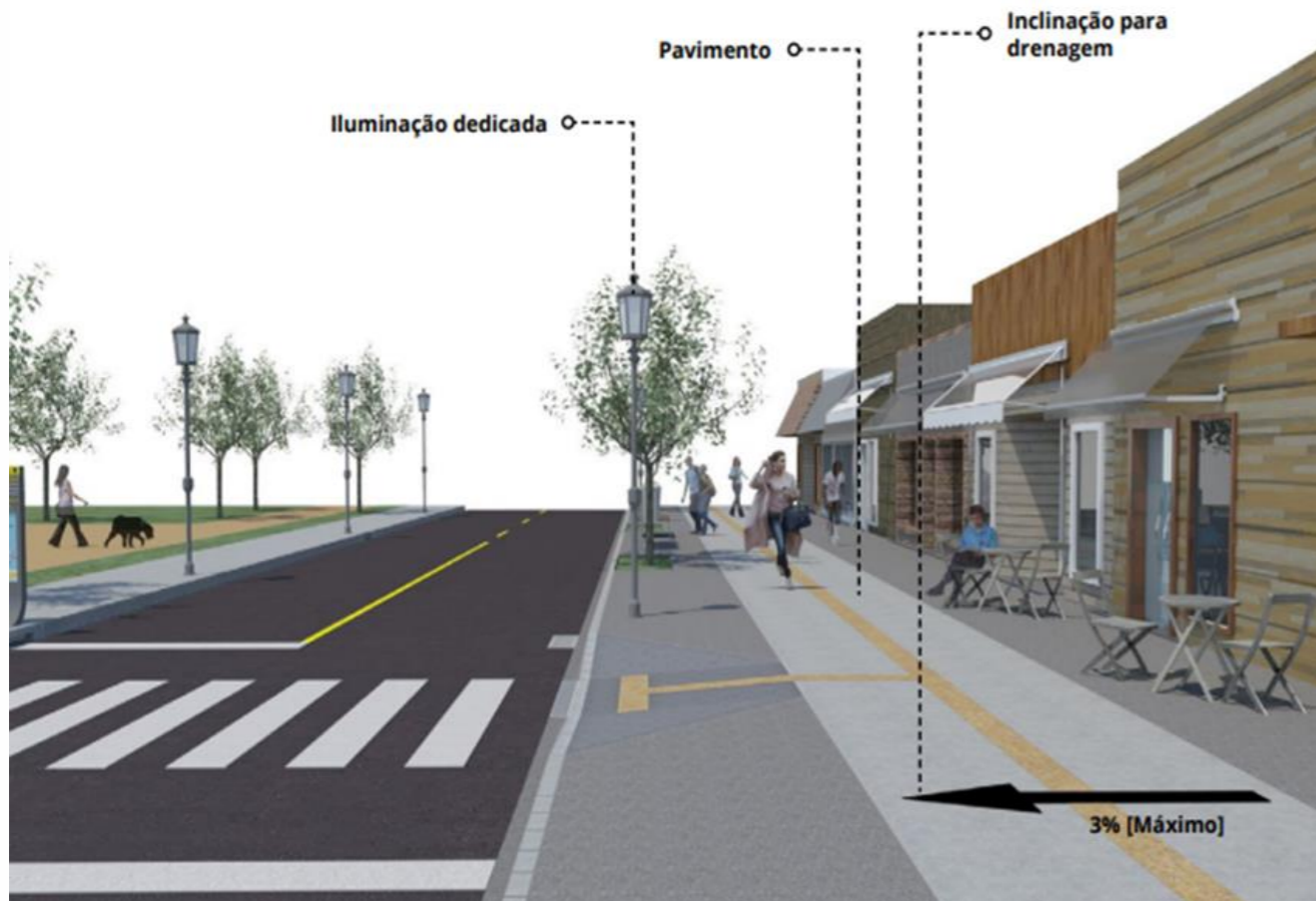
Figura 86 – Exemplo de calçada
